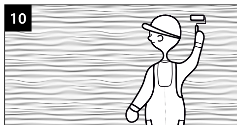
Przed przystąpieniem do malowania, powierzchnię paneli należy zagruntować środkiem Weldprimer przy użyciu wałka welurowego.
